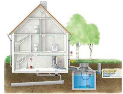
Principe des cuves enterrées et utilisations possibles de l'eau pluviale stockée
